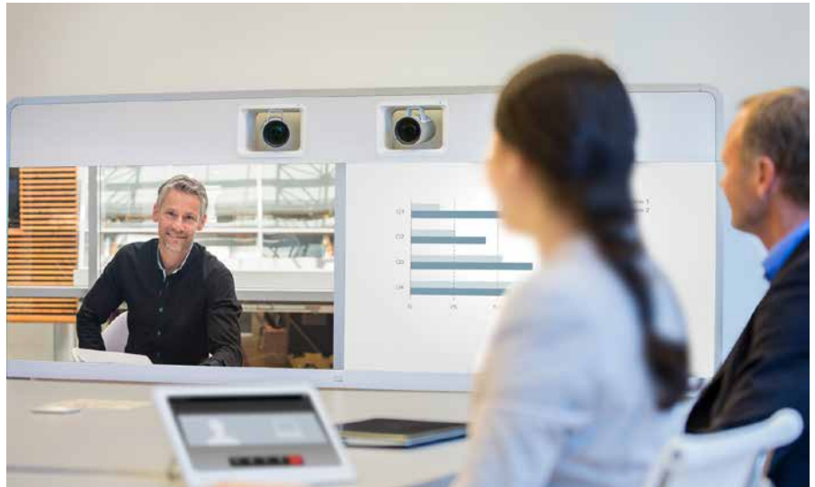
Telepresence System für große Meetingräume mit 2 Kameras für Speaker-Track.
